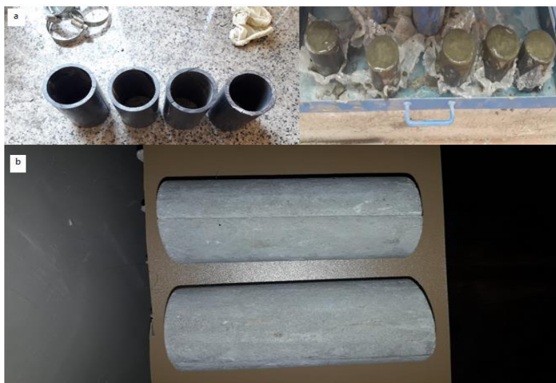
شکل ۲. (a) لوله‌های PVC برای آماده سازی نمونه‌ها (b) نمونه‌های آماده شده برای تعیین خواص فیزیکی و مکانیکی.
