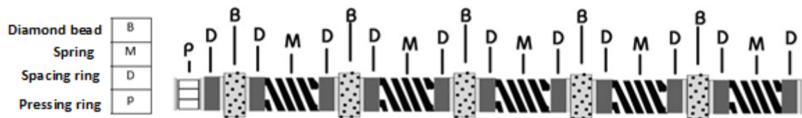
شکل ۱. یک واحد سیم برش یا سگمنت به همراه جزئیات (Ozcelik, 1999)
