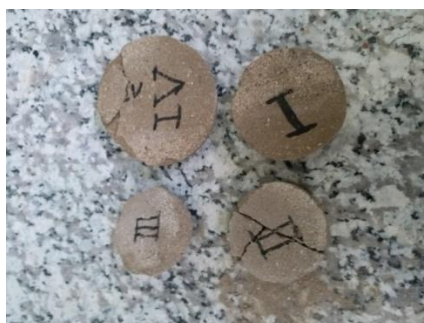
شکل ۸. نمونه‌ی کلوخه شده خاک پس از تیمار به روش MICP
