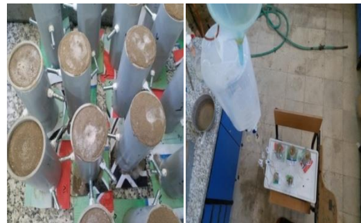
شکل ۵. تزریق نمونه‌ها با سیستم سرم و سوزن تزریق
