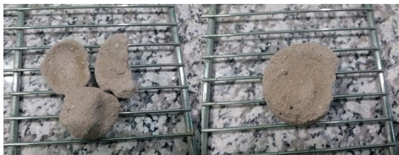
شکل ۷. نمونه‌ی کلوخه شده خاک پس از تیمار با روش MICP
