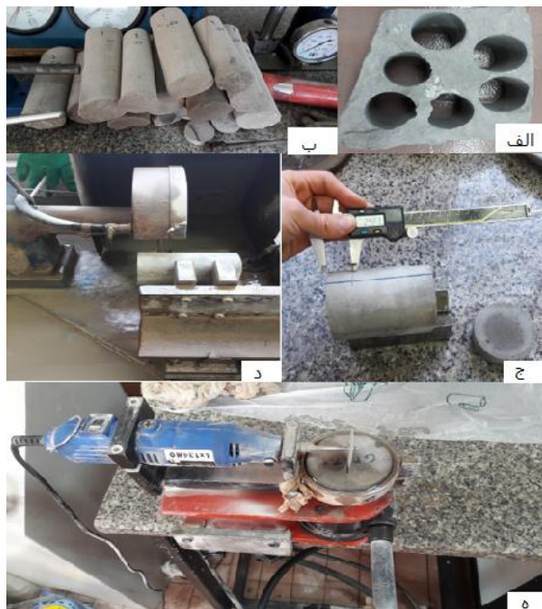
شکل ۶. مراحل آماده‌سازی (الف) مغزه‌گیری از بلوک سنگی، (ب) مغزه‌های بدست آمده از بلوکهای ماسه‌سنگ، (ج) علامت زدن مغزه‌ها در ضخامت معین توسط کولیس، (د) برش مغزه به ضخامت مورد نظر توسط دستگاه برش و (ه) فرز انگشتی جهت ایجاد شکاف چورون.
