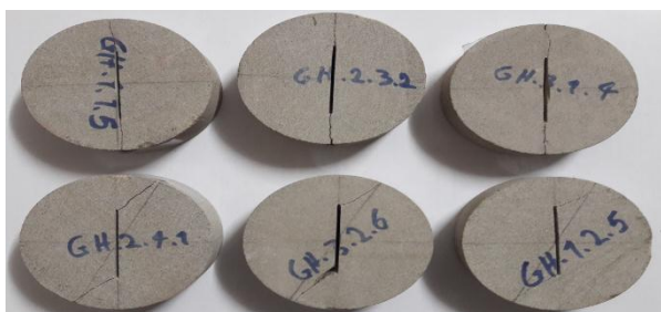
شکل ۸. تصاویر تعدادی از نمونه های ماسه سنگ دارای ترک چورون پس از شکست (ردیف اول: مود I، ردیف دوم: مود II).
