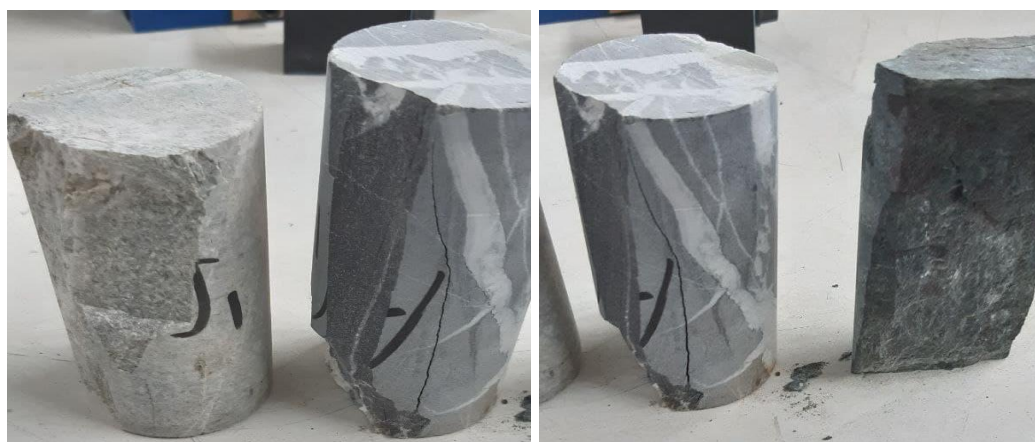
شکل ۵. شکل شکست تعدادی از نمونه‌ها بعد از انجام آزمایش مقاومت فشاری تک محوره.
