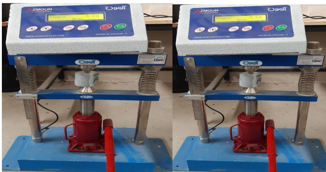
شکل ۶. انجام آزمایش بار نقطه‌ای و نحوه قرارگیری نمونه در بین صفحات بارگذاری دستگاه.
