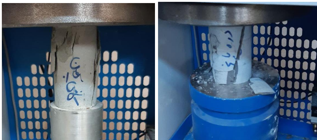
شکل ۴. آزمایش مقاومت فشاری تک محوره و نحوه شکست نمونه.
