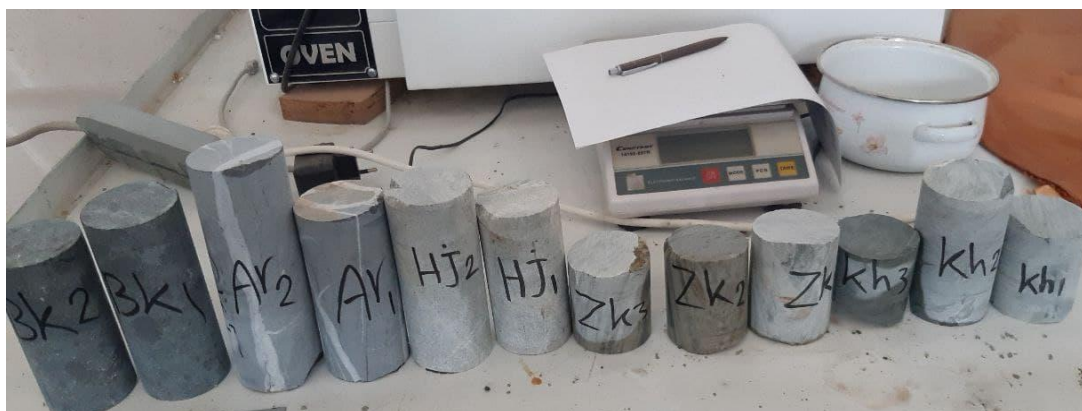
شکل ۳. تعدادی از نمونه‌های مغزه‌ای تهیه شده برای انجام تست‌های آزمایشگاهی.
