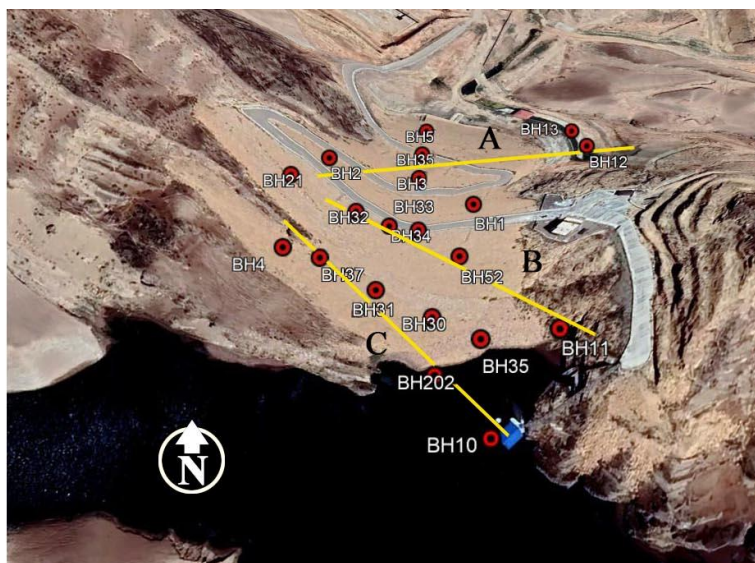
شکل ۷. موقعیت گمانه های سد ایبورد (راست) و پروفیل تغییرات لوژن در گمانه های اکتشافی در سه راستای مختلف (چپ).
