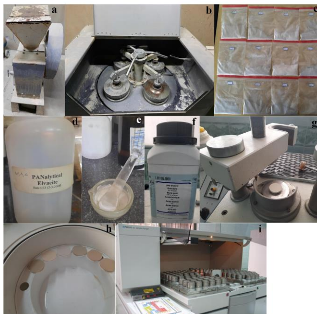
شکل ۵. تصاویر آماده سازی نمونه برای آزمایش XRF، تصاویر؛ (a) خرد کردن سنگ، (b) پودر کردن سنگ، (c) پودر سنگ، (d و e) مخلوط کردن پودر سنگ با چسب مخصوص، (f) پودر مورد استفاده در ته نمونه های قرص شکل، (g) پرس کردن پودر سنگ و تبدیل آن به نمونه های قرص شکل، (h) نمونه های قرص شکل، (i) قرار دادن نمونه های قرص شکل در دستگاه
