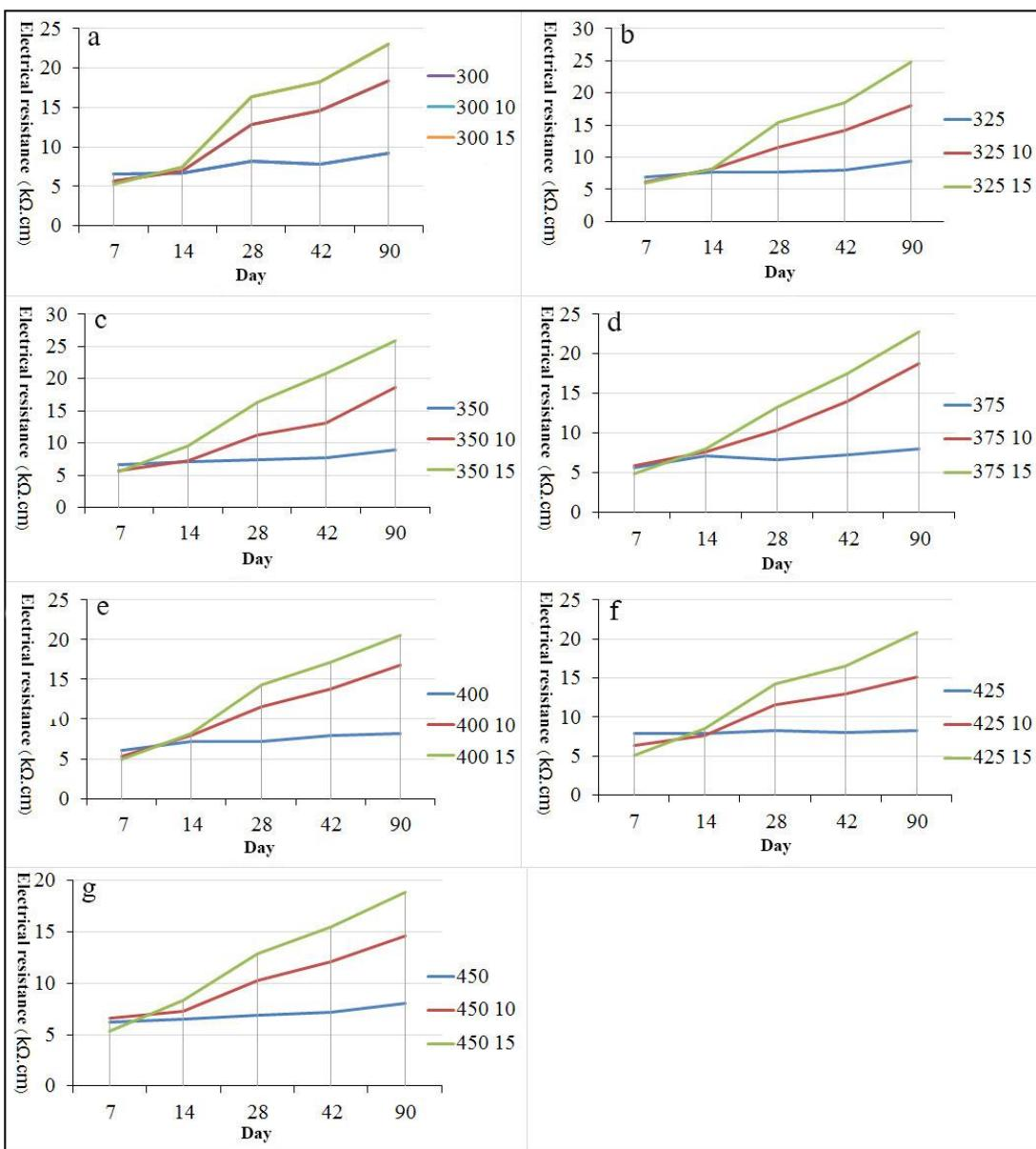
نکته: خط آبی: نمونه فاقد زئولیت، خط قرمز: نمونه با ۱۰٪ زئولیت و خط سبز: نمونه با ۱۵٪ زئولیت
