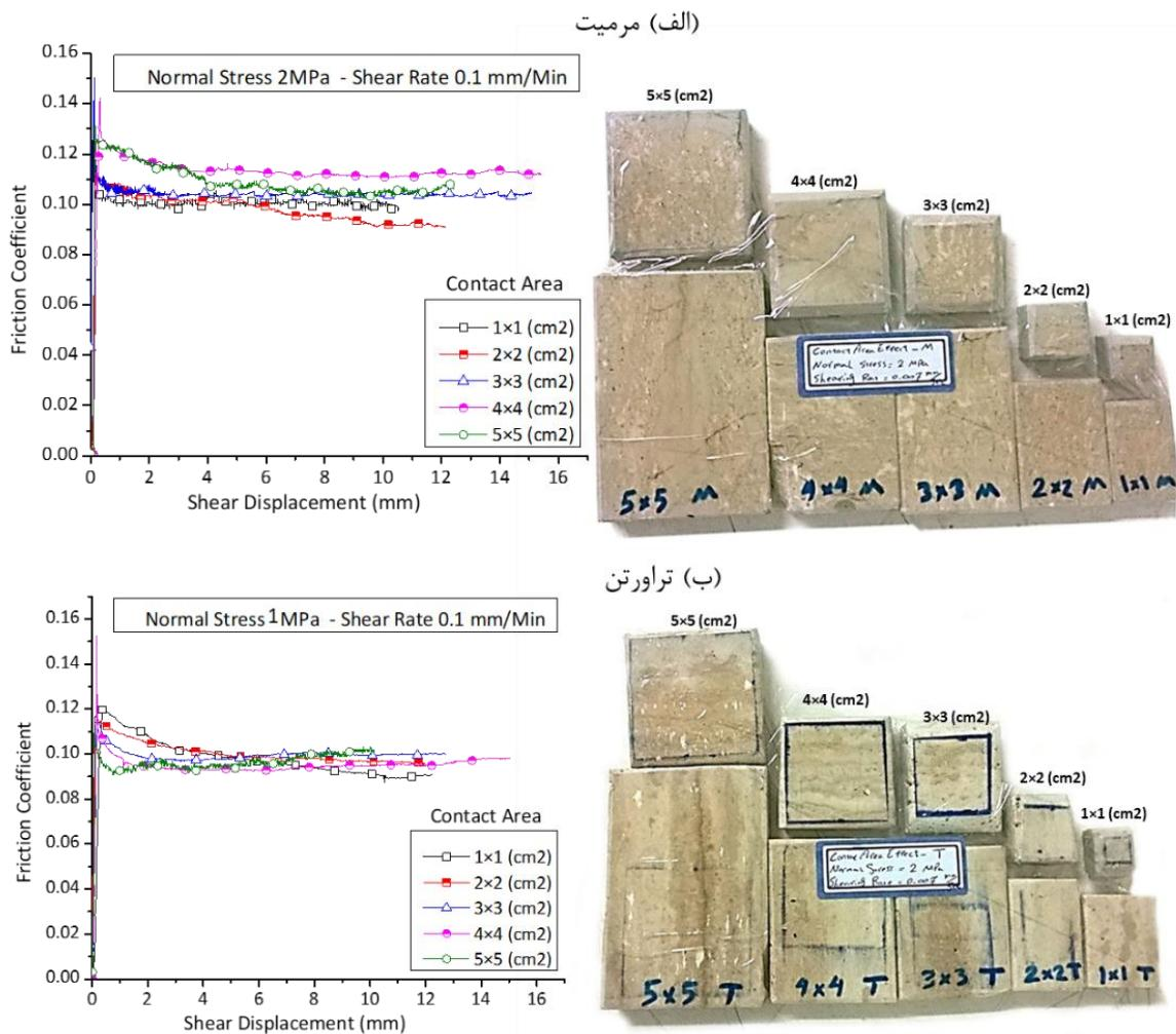
شکل ۲. رفتار اصطکاکی سطوح صاف سنگی با مساحت‌های تماس ۱، ۴، ۹ و ۲۵ سانتی‌متر مربع، تحت آهنگ جابجایی برشی ۰/۱ میلی‌متر بر دقیقه. (الف) درزهای صاف مرمریت تحت تنش عمودی ۲ مگاپاسکال. (ب) درزهای صاف تراورتن تحت تنش عمودی ۱ مگاپاسکال.
