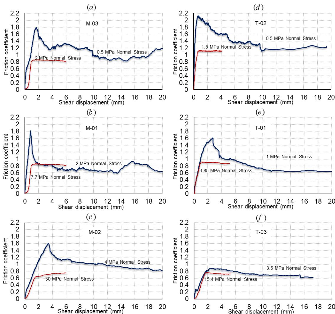
شکل ۳. مقایسه رفتار برشی درزه‌های زبر استاندارد  $80 \times 70$  میلیمتر با درزه‌های صاف کوچک  $10 \times 10$  میلیمتر که طی مرحله برش پسماند تحت تنش‌های عمودی تقریباً یکسانی قرار گرفته‌اند. منحنی‌های a، b و c مربوط به نمونه‌های مرمریتی بوده و منحنی‌های d، e و f نیز مربوط به تراورتن هستند.
