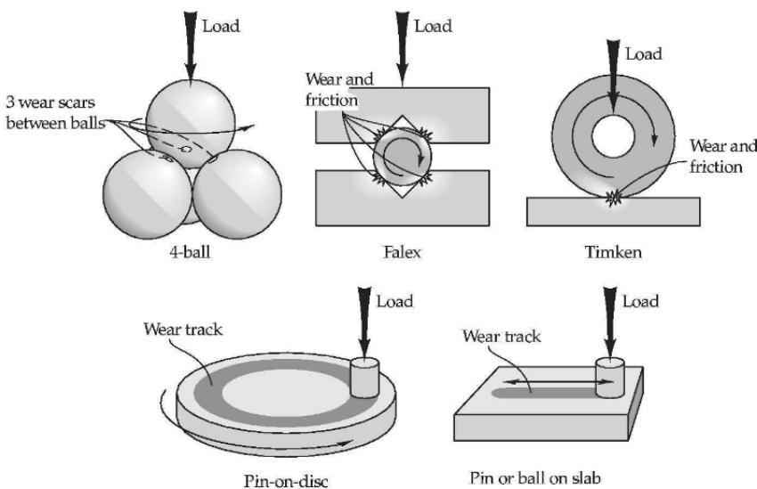
شکل ۵. طرح شماتیک سازوکارهای اساسی تریبومترهای مرسوم در مطالعات تربیولوژیکی (Stachowiak, and Batchelor, 2004)
