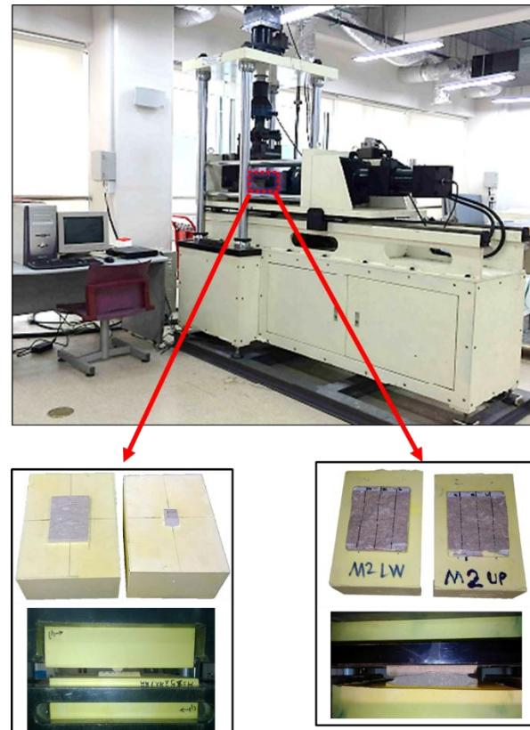
شکل ۱. دستگاه آزمایش برش مستقیم خودکترل و انواع نمونه‌های مورد آزمایش (آزمایشگاه مکانیک سنگ دانشگاه ملی سئول).
