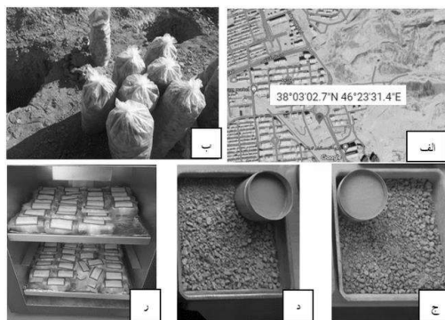
شکل ۱. تهیه نمونه‌ها، الف. موقعیت جغرافیایی محل نمونه برداری ب. نمونه‌های تهیه شده از منطقه نصر تبریز ج. مارن زرد د. مارن سبز ر. نمونه‌های ساخته شده در حال عمل آوری
