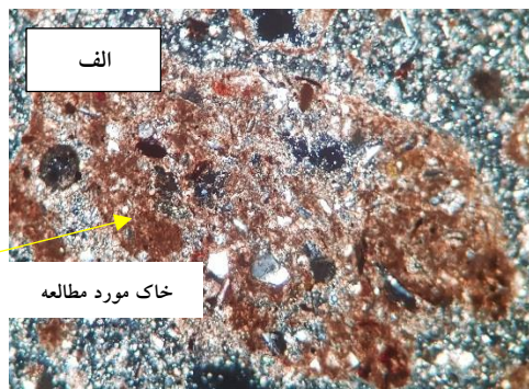
شکل ۱۶. تصاویر پتروگرافی تاثیر پرلیت بر روی لای مورد مطالعه قبل و پس از تثبیت، الف: خاک مورد مطالعه، ب- خاک مورد مطالعه به همراه ۳ درصد پرلیت و ۲ درصد هیدروکسید کلسیم.
