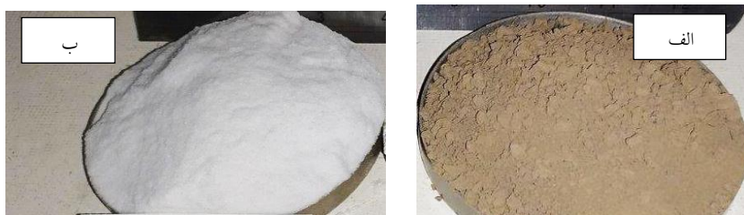
شکل ۴. تصاویر مصالح مورد استفاده در تحقیق حاضر، الف- لای شور سدیمی، ب- پرلیت.
