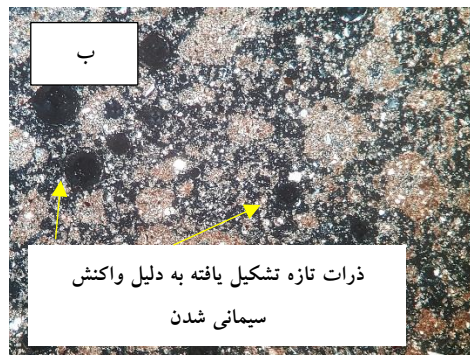
شکل ۱۶. تصاویر پتروگرافی تاثیر پرلیت بر روی لای مورد مطالعه قبل و پس از تثبیت، الف: خاک مورد مطالعه، ب- خاک مورد مطالعه به همراه ۳ درصد پرلیت و ۲ درصد هیدروکسید کلسیم.
