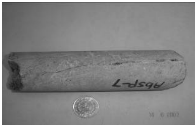
شکل ۱- گسترش تخلخل کانالی در اثر پیشرفت انحلال در سطح درزه که منجر به کاهش مقاومت سنگ می‌گردد.
