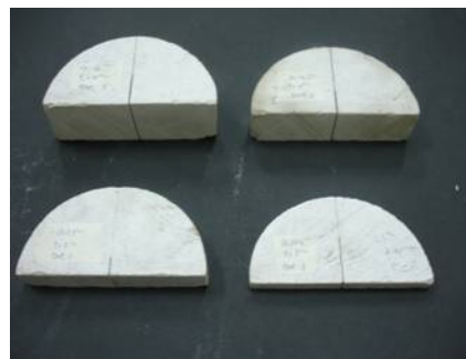
شکل ۵- نمونه ای از قطعات که تحت مود I بارگذاری تست شده اند
