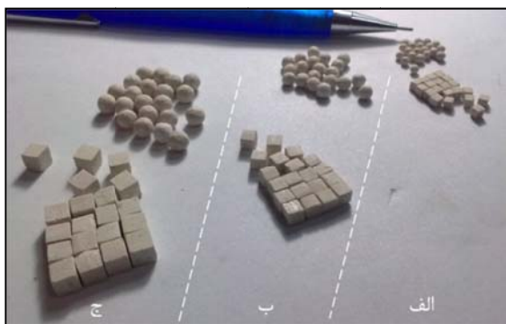
شکل ۸. خرده‌های سنگ آهکی تهیه شده با ابعاد: الف) ۲ میلی‌متر، ب) ۳ میلی‌متر و ج) ۴ میلی‌متر. نمونه‌های کروی شکل جهت آزمایش بارگذاری مستقیم (SCS) و نمونه‌های مکعبی شکل به منظور آزمایش نفوذ استاتیک (SRP) آماده‌سازی شده‌اند.
