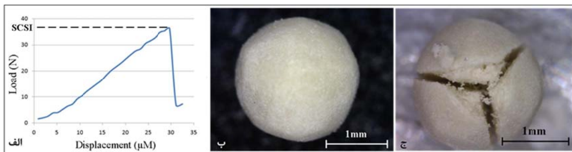
شکل ۹. الف) نمودار رفتاری خرده‌های آهکی در آزمایش بارگذاری. ب) سنگ آهک‌های میکرایتی قبل و ج) بعد از آزمایش بارگذاری
