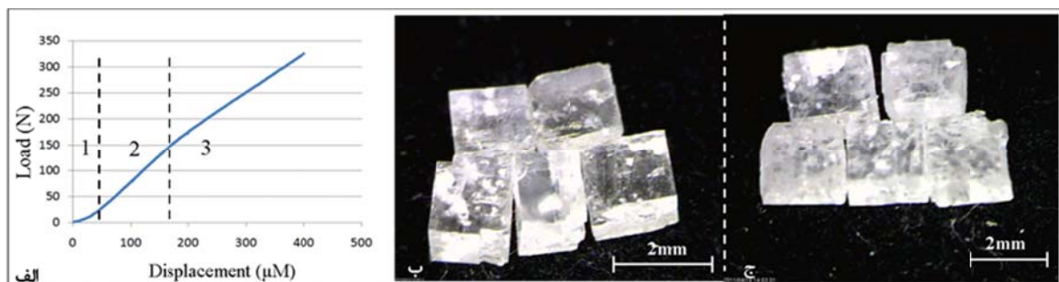
شکل ۶. الف) نمودار رفتاری بلورهای نمک در آزمایش بارگذاری، (ب) بارگیری، (ج) محدوده رفتار شبه الاستیک (۳) محدوده رفتار پلاستیک (ب) بلورهای نمک قبل از بارگذاری و ج) تغییر در شفافیت بلورهای نمک بعد از بارگذاری
