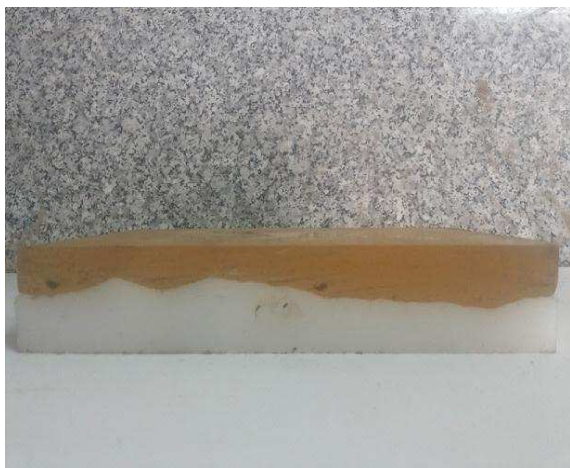
شکل ۴. یک جفت از پروفیل های زبر ساخته شده بر روی پلاستیک فشرده
