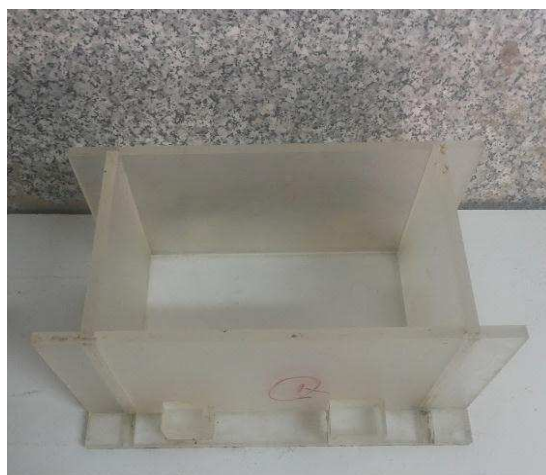
شکل ۳. قالب پلکسی گلاس مورد استفاده جهت ساخت نمونه ها
